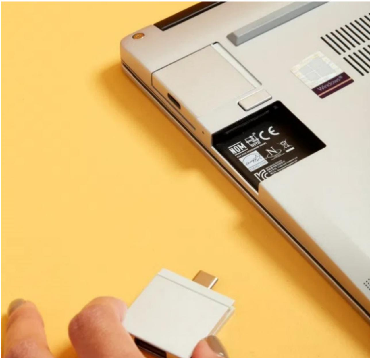
Fonctionnement par modules interchangeables du Framework Laptop. Photo : [frame.work](https://www.frame.work).
