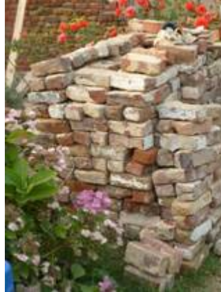
Des briques nettoyées et prêtes à être réutilisées.
